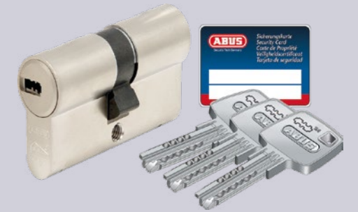
PROFILZYLINDER, SICHERHEITZYLINDER MIT SICHERUNGSKARTE (NACHBESTELLSCHUTZ), INKL. 5 SCHLÜSSEL. WENDESCHLÜSSELSYSTEM MIT 4 STIFTREIHEN
